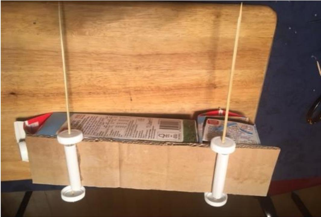
Bild 5: Die Räder werden mit den Schaschlik-Stäbchen versehen und in die Strohhalm gesteckt.
